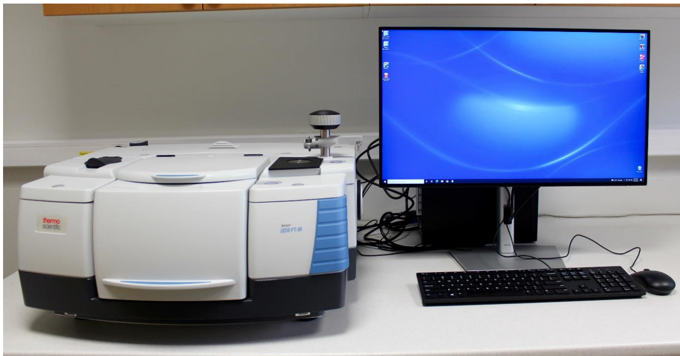
Mynd 16. Nicolet iS50 FTIR innrauður litrófsmælir sem nýttist til rannsókna á sameindum.
