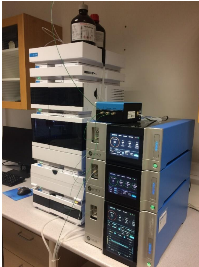
Mynd 17. Wyatt gelflæðigreininir (GPC), nýttur til mælinga á þyngd, stærð og lögun fjölliða og próteina.
